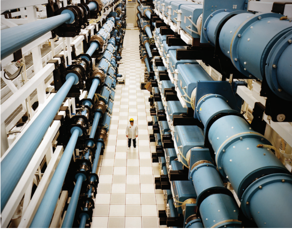
7.6 pav. Galingiausias XX a. optinis lazeris Nova , sukurta Lawrence Livermore National Laboratory (JAV). Jo impulso galia siekė 1500 TW.
