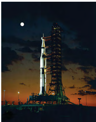
9.7 pav. Galingiausia ir didžiausia kosminė raketa „Saturn“ ant paleidimo platformos. Ja buvo skraidinami į Mėnulį „Apollo“ erdvėlaiviai, iškeliami į orbitą aplink Žemę didelės masės palydovai.
