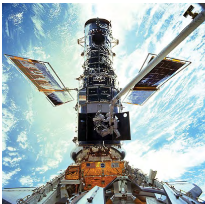
9.11 pav. Hablo kosminis teleskopas, kuriuo buvo padaryta daug astronomijos atradimų. Prie jo, atvirame kosmose, matyti astronautas, taisantis teleskopo gioskopus – prietaisus, orientuojančius jį norima kryptimi.
