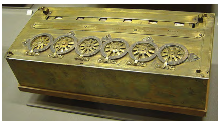
9.13 pav. Blezo Paskalio XVII a. sukurta aritmetinė mašina. Ja naudojantis, buvo galima sudėti ir atimti skaičius.
